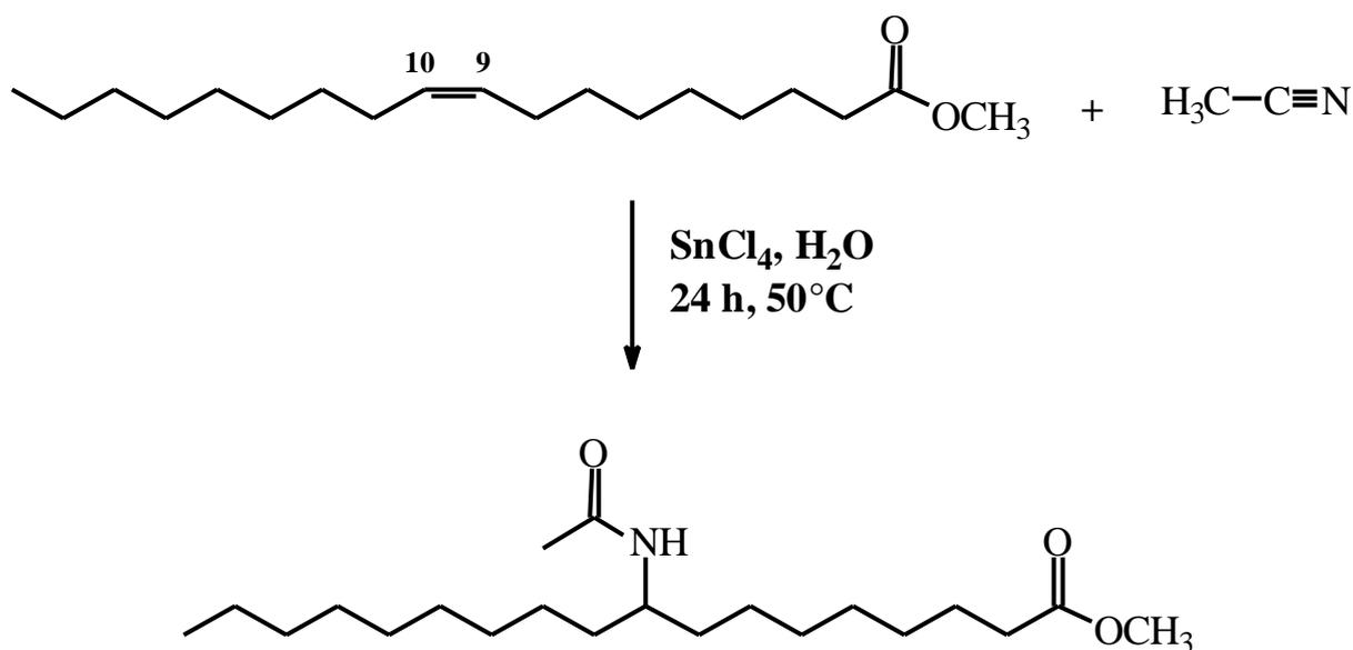
**Abb. 16: SnCl<sub>4</sub>-induzierte Ritter-Reaktion von Ölsäuremethylester und Acetonitril**
