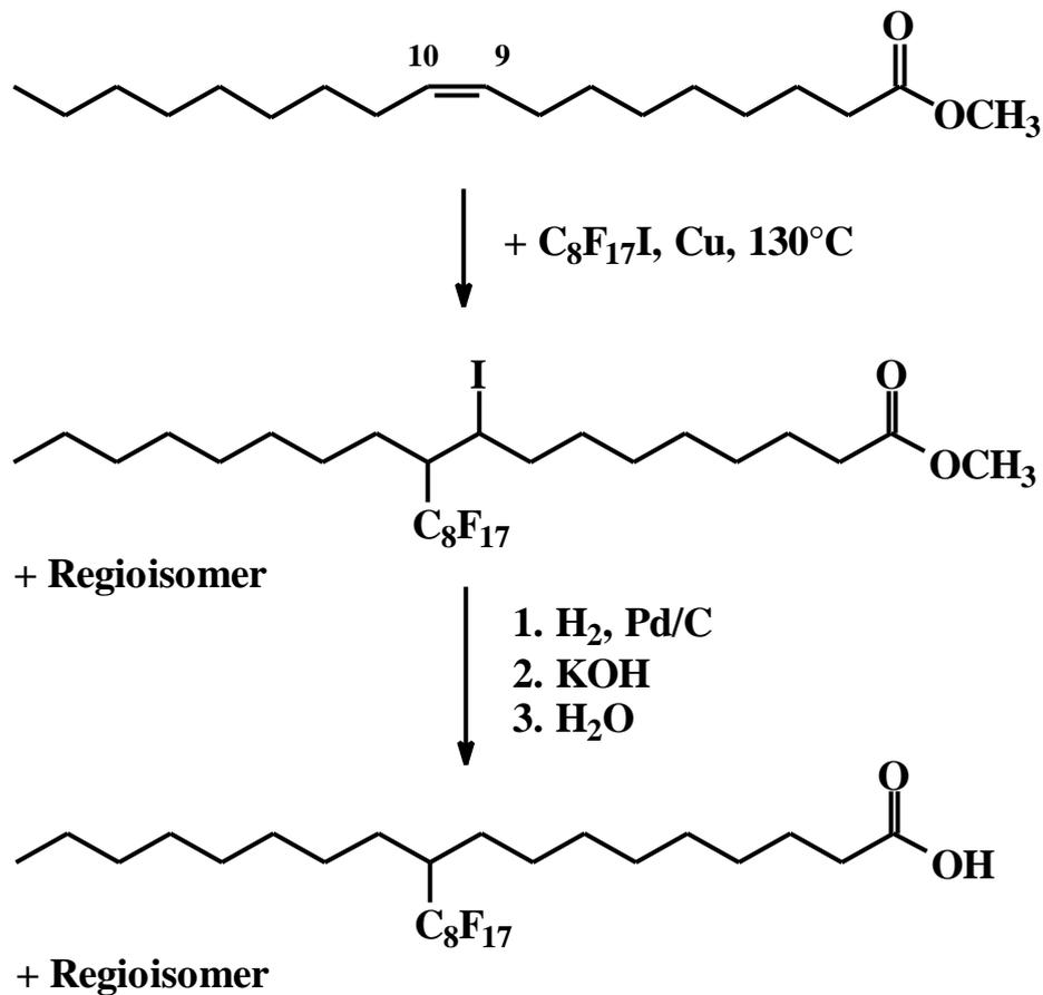
**Abb. 11: Kupfer initiierte Addition von Perfluorooctylidid an Ölsäuremethylester**
