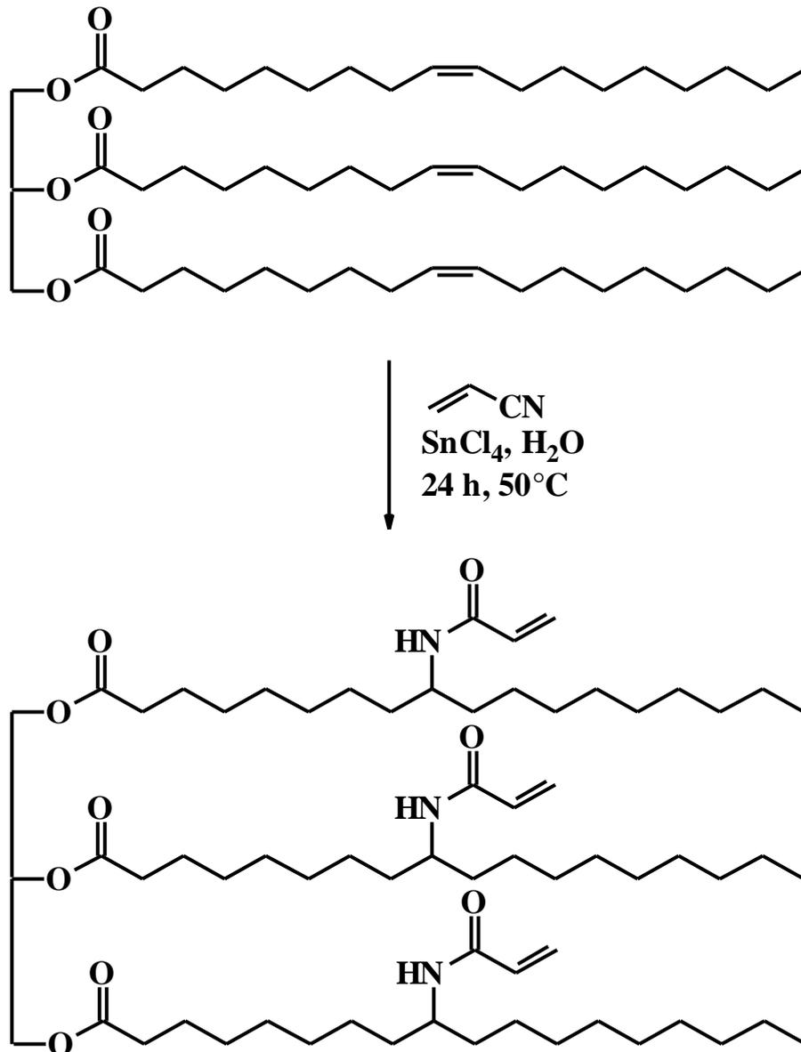
**Abb. 17:  $\text{SnCl}_4$ -induzierte Addition von Acrylnitril an Rüböl (ölsäurereich)**
